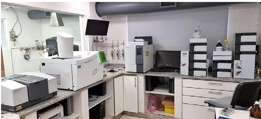
**“La planta cuenta con un laboratorio de control de calidad analítico y fisicoquímico, equipado con espectrofotómetros UV-Visible, espectrofotómetros de radiación infrarroja FTIR, cromatógrafos gaseosos, cromatógrafos líquidos (UFLC, HPLC), espectrofotómetro de absorción atómica, analizador de tamaño de micro y nanopartículas”.**
